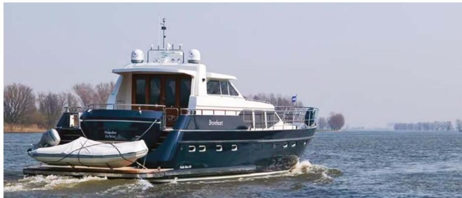
В линейке «Pacific S» шесть яхт длиной от 17,8 до 22,8 м, шириной от 5,45 до 5,85 м, водоизмещением от 43 до 48 т. Они также имеют океанскую категорию плавания и выполнены в едином для линейки архитектурном стиле, весьма близком к яхтам «Pacific P». В этой линейке мы вновь видим два основных конструктивных материала корпуса (сталь и стеклопластик).
