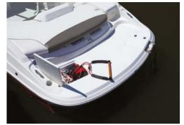
Ушли в прошлое крупные прямоугольные решетки воздухозаборников моторного отсека. Теперь они спрятаны в нише под кормовым лежаком, уменьшились в размерах и стали круглыми. С правого борта удобный проход с кормы в кокпит, чего ранее не было. Съемную подушку плоского кормового дивана можно приподнять и установить на кронштейн. Тогда вы получите удобный шезлонг для загара. Под диваном, в нише, расположился переносной кулер.
