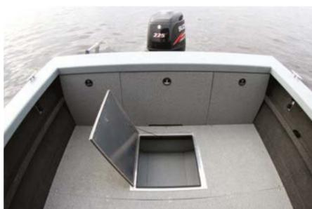
характеризует работу инженеров компании Weldcraft. Полость, сформированная двумя основными секциями: корпуса и кокпита — заполнена вспененным полиуретаном, который не только обеспечивает аварийную плавучесть катера, но и весьма эффективно гасит структурный шум, а уж как могут громыхать алюминиевые лодки, мы помним еще с эпохи «Казанок». Здесь не происходит ничего и близко похожего! По форштевню, килю, привальнику идет специальный профиль, усиливающий эти места, ведь им первыми, случись
