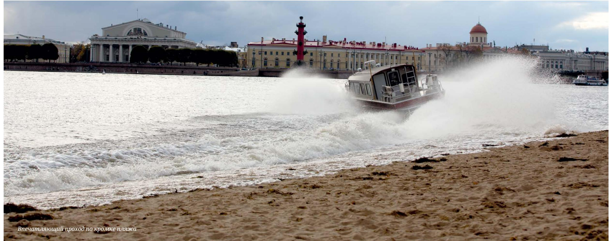
лодку и на месте. В ее исключительной маневренности я убеждаюсь очень скоро, высаживая людей на берег и снова забирая их на борт. Два двигателя позволяют мне работать, как на машине с гусеницами (танке или тракторе), пуская их враздрай, я кручуясь на месте, мягко корректирую курс и положение лодки на подходе к маленьким скальным площадкам и камням.
