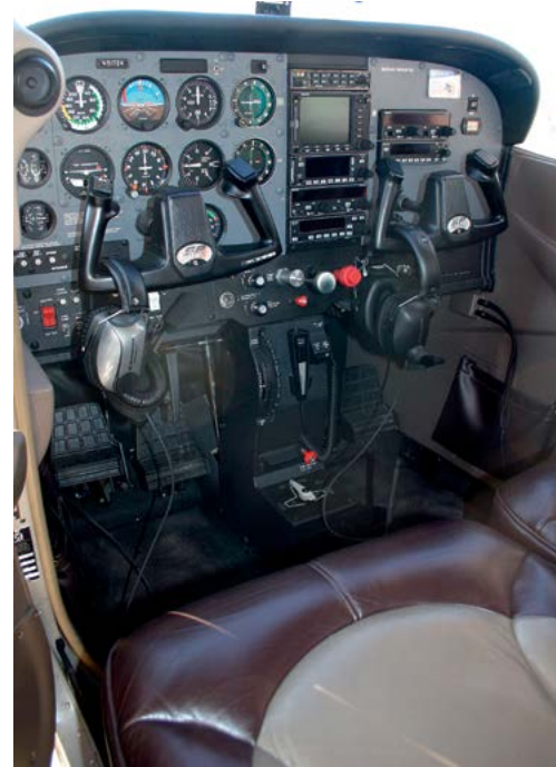
«Стекланный кокпит» — давно уже не атрибут одних только многотонных лайнеров. Судя по приборам, подлетаем к мысу Морьин нос на Ладозе — высота 1150 футов, скорость 110 узлов, боковой ветер — 14 узлов
