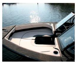
19-го — днище из цельного листа, без сварки по килевой линии, подкрепленное изнутри хитрым набором из часто отформованных гофр, что является дополнительным фактором прочности и надежности. Лодка удивительно тихая, поскольку «задута» изнутри пенополиуретаном, причем в правильных местах. »
