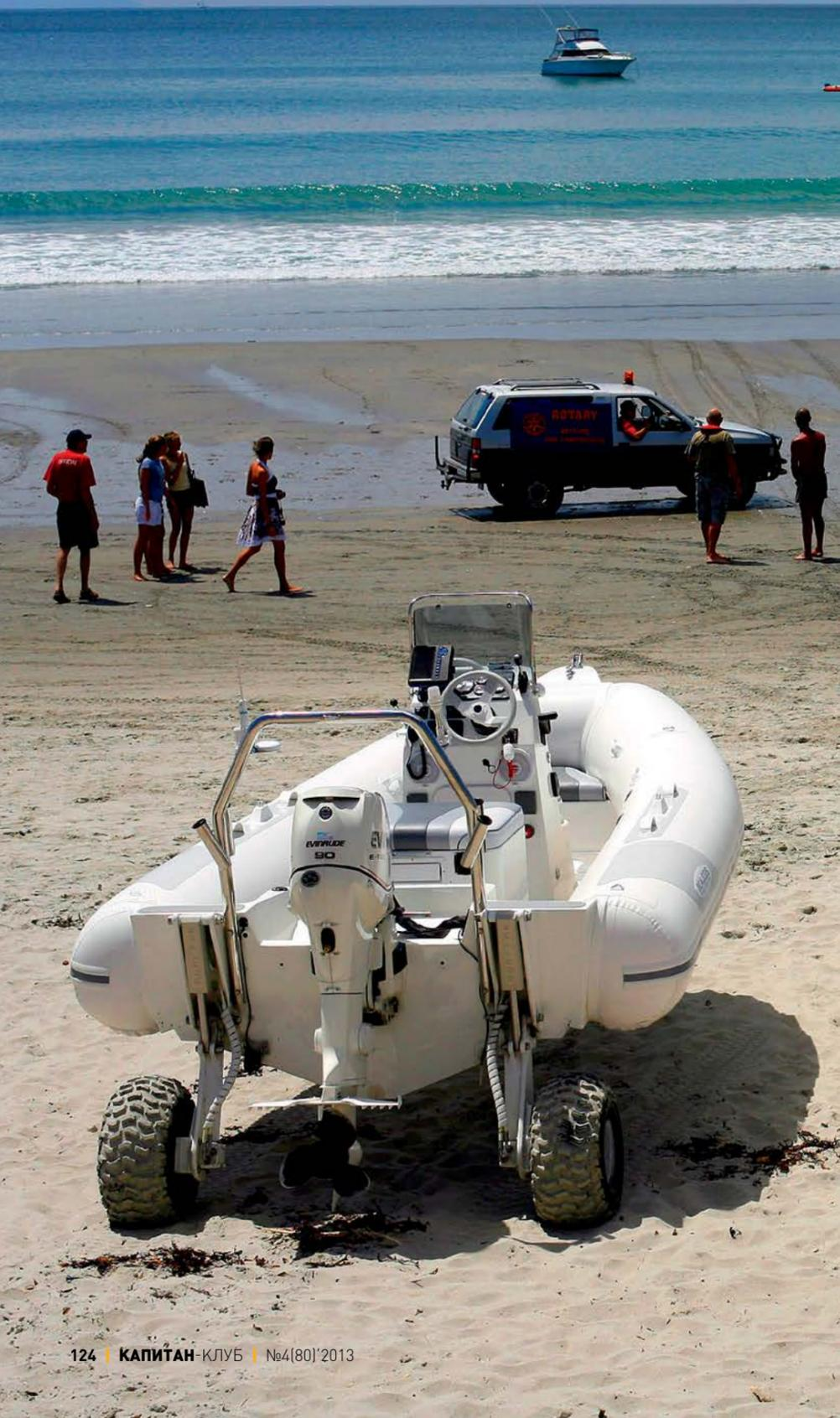
*Гидравлика позволяет передавать большую мощность на расстояние по гибким шлангам без использования валов, карданных шарниров, сальников и прочих классических автомобильных и судовых атрибутов*
