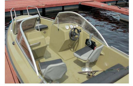
ником из устойчивого к ударам и истиранию синтетического материала. Внутреннее пространство между секциями заполняется вспененным полиуретаном, придающим дополнительную прочность всей конструкции, а также являющуюся сплошным блоком непотопляемости. Стеклопластик кокпита очень хорошо моется обычной водой.
