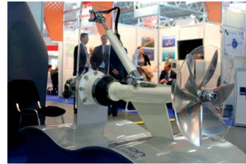
Привод Арнесона для высокоскоростных судов на стенде компании Twin Disk
