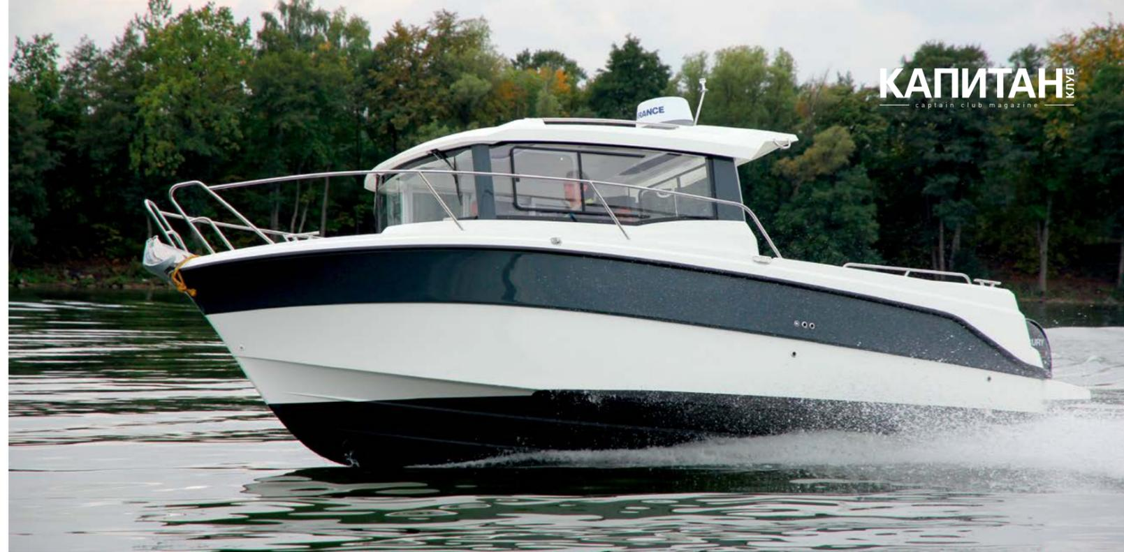
со свободными проходами по бокам, преимуществами которой для судов подобного назначения очевидны: освобождающегося на лодке пространства, необходимого при рыбалке, хоть отбавляй. При довольно компактных по сравнению с надстройкой Weekend габаритах рубка Parker 800 Pilothouse все же мало напоминает классическую «будку», обычно пред-
