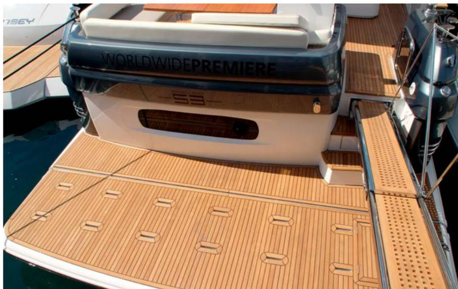
Панель («переклейка») наружного палубного настила. С успехом может использоваться для укладки в помещениях
