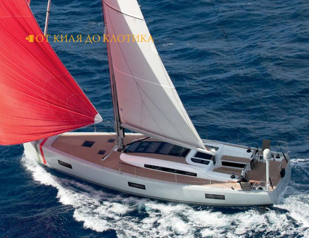
Остойчивость гарантируется сильно заглубленным свинцовым Т-образным фальшкилем (осадка 2,95 м). А для легкой «работы» с волной все тяжелые элементы яхты (двигатель, баки, аккумуляторы) сосредоточены близ ее центра тяжести.
