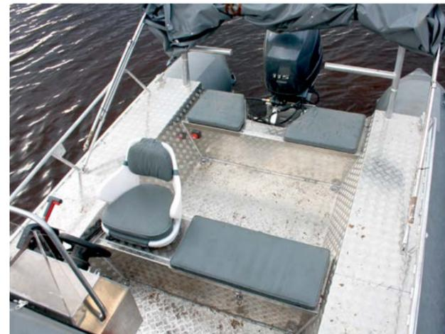
Катамаран, представляющий собой прямоугольную в плане просторную платформу, предоставляет широкий простор для компоновочных решений. В отличие от своего стеклопластикового предшественника, оборудованного стационарной каютой, алюминиевый «Ротан» — изначально открытый, с «мягкой» съемной рубкой-убежищем (дополняемой при необходимости более высоким кормовым тентом) и просторным кокпитом во всю длину жесткого корпуса.
