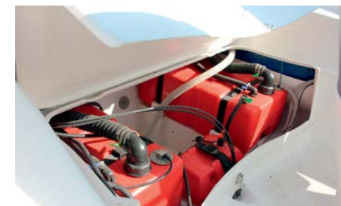
Топливные баки и аккумулятор под сиденьем кормового дивана. Все очень удобно, компактно и доступно. По желанию возможно размещение топливных баков в консолях
