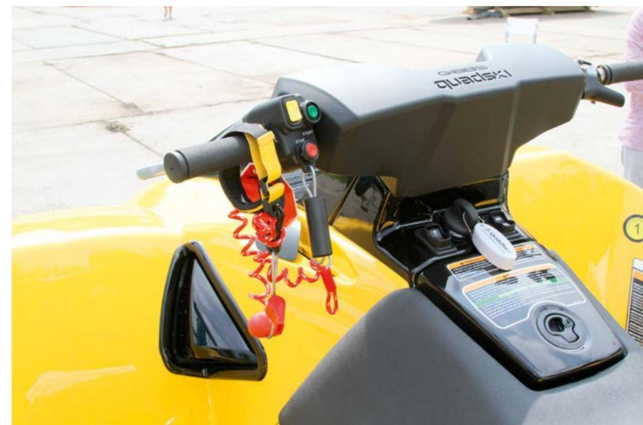
На левой рукоятке руля — рычаг тормоза, клавиша переключения передач (желтая), кнопка заднего хода (зеленая) и кнопка «старт/стоп» (красная, дополненная аварийным выключателем зажигания со стропкой); на правой — только курок газа. Справа от замка зажигания расположены кнопки включения «сухопутного» и «водяного» режимов (помимо звуковой сигнализации, на приборной панели со спидометром и указателем уровня топлива загорается соответствующий символ), слева — клавиша включения фар и габаритных огней
