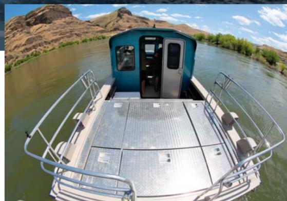
лишь большая плавательная платформа с лестницей для купания и транцем для дополнительного подвесного мотора. Впрочем, все это обширное пространство не в ущерб простору может быть доукомплектовано опциональным оборудованием. Высокие релинги в кормовой части не только служат для большей безопасности пассажиров, но и являются креплением для дополнительных кормовых сидений. А в центральной части кокпита можно поставить столик.
