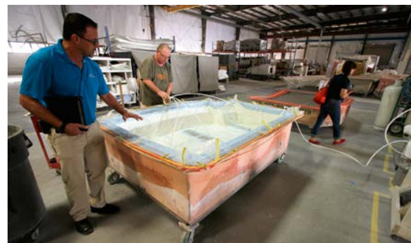
Ряд корпусных деталей формируется передовым методом вакуумной инфузии, обеспечивающим высокую прочность при малом весе
