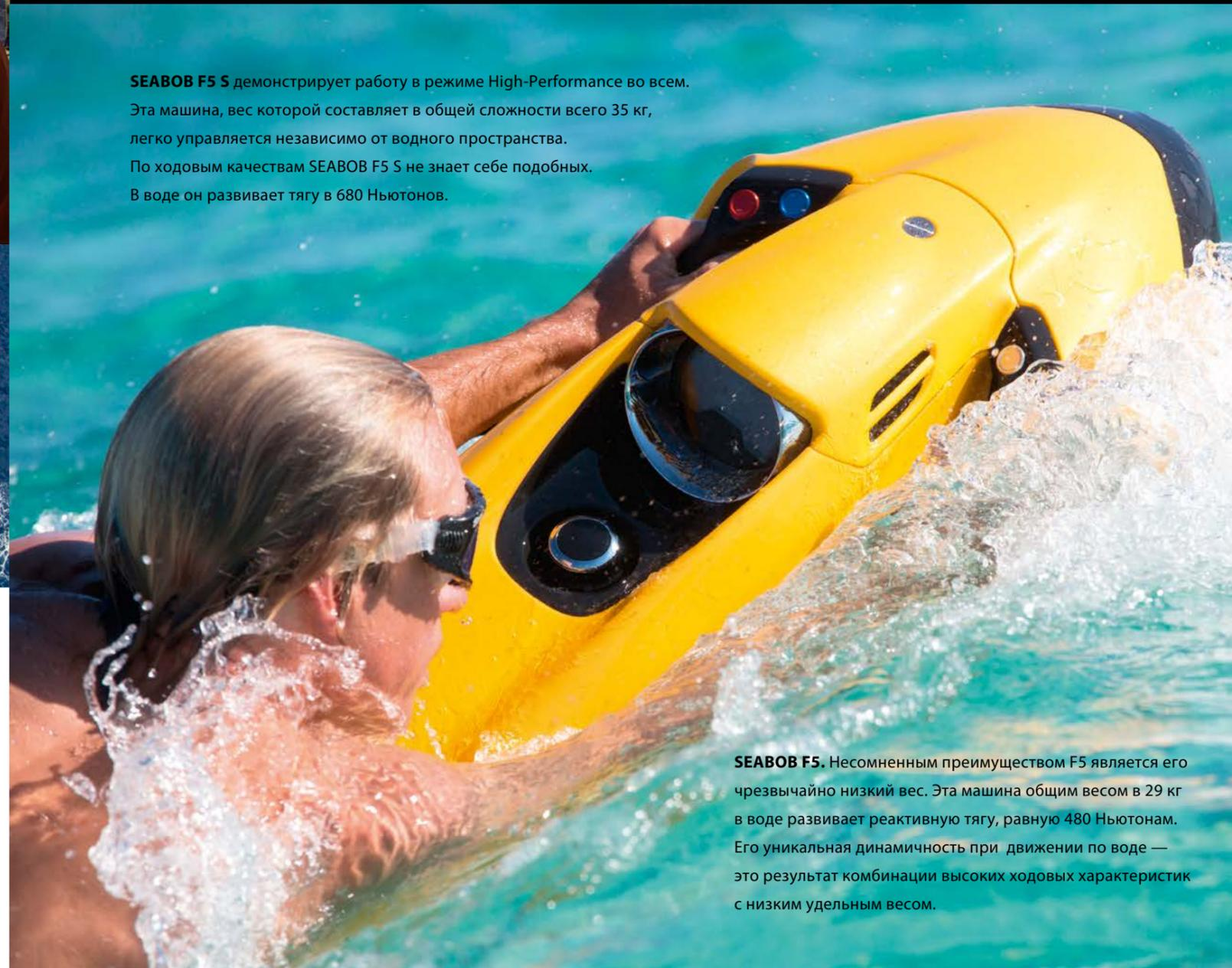
SEABOV F5. Несомненным преимуществом F5 является его чрезвычайно низкий вес. Эта машина общим весом в 29 кг в воде развивает реактивную тягу, равную 480 Ньютонам. Его уникальная динамичность при движении по воде — это результат комбинации высоких ходовых характеристик с низким удельным весом.
