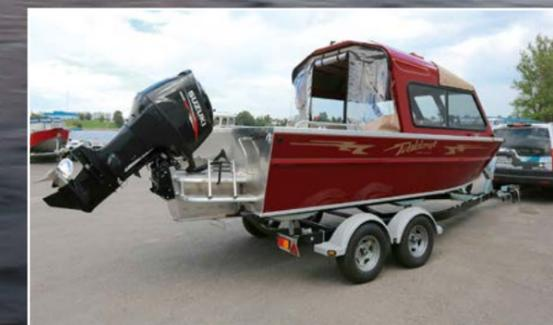
ности изготовления рамы ветровых стёкол. В ней дверца, плотно закрывающая проход на носовую палубу. Передняя часть кокпита накрыта полурубкой-хардтопом с полноразмерными, обеспечивающими прекрасный боковой обзор боковыми стёклами, заимствованными у «старшей» серии Ocean King. Стёкла сдвижные и дополнены москитными сетками, так что в жару рубка не превраща-»
