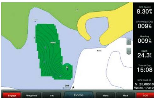
*По мере движения лодки программа создаёт карту реального подводного рельефа с привычными изобатами*
