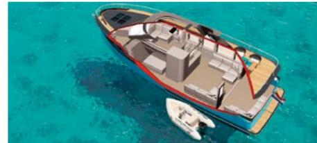
Переработанная версия модели Steeler Panorama 46. Вместо стального корпуса — алюминиевый, вместо 11-узловой ходы — впечатляющие 33 узла, до которых яхту разгоняют два двигателя Yanmar по 480 «лошадей». Кроме того — нормальная плавательная платформа на транце вместо «огрызка», как на
