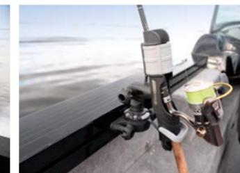
**Планширь-«монорельс» позволяет легко устанавливать по периметру лодки любые аксессуары со стандартной ответной частью — начиная от «стаканов» для удильниц и заканчивая кронштейнами для мобильных телефонов и даже небольшими столиками**
