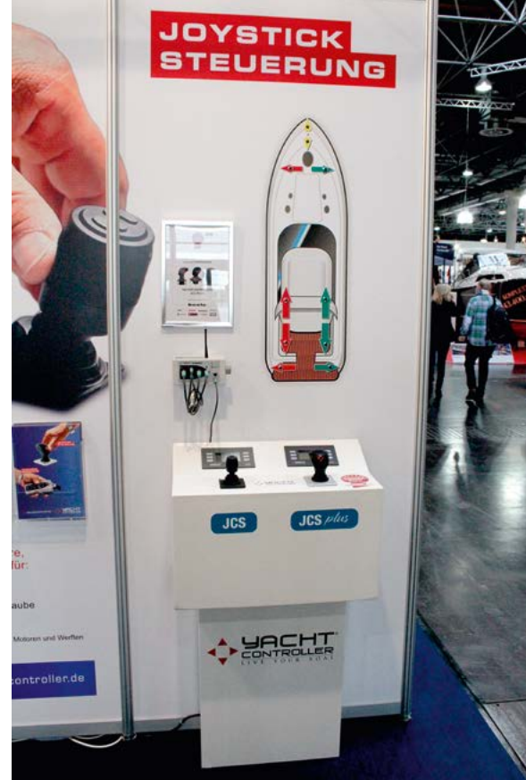
За счет носового подруливающего устройства с изменяемой тягой джойстиковая система маневрирования стала доступна на лодках с классическими прямыми валами.
