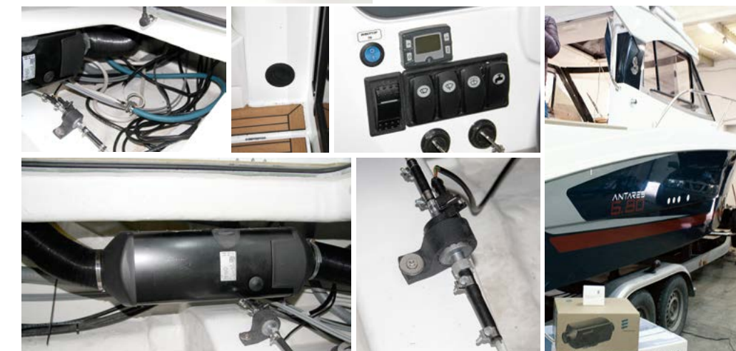
Установка воздушного отопителя Eberspächer Airtronic на моторной яхте Beneteau
