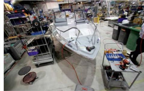
пенополиуретановая «начинка» эффективно гасит характерный для металлической лодки шум, а также с запасом обеспечивает аварийную непотопляемость. Остается соединить эти секции с мощным транцем и днищем, «висячий» набор которого тоже исключает возможные коробления, — и абсолютно жесткий, не требующий каких-либо дополнительных подкреплений корпус готов.
