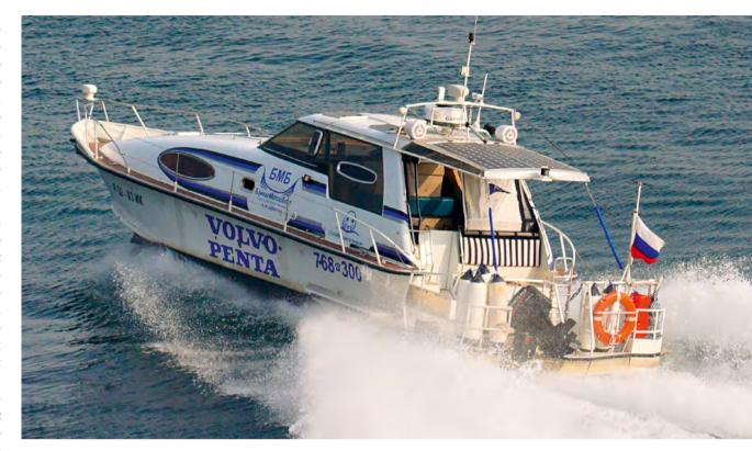
Высокая скорость, достигаемая за счет эффективной крыльевой системы, означает еще и низкий путевой расход топлива. На крейсерских 44 узлах «БМБ-14М» способен без дозаправки покрыть расстояние в 1000 морских миль. Подобной автономностью по топливу могут похвастать разве что водоизмещающие яхты, только вот на преодоление такой дистанции у них уйдет не 23 часа, а от 4 до 6 суток
