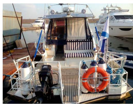
не ширина корпуса по скуле составляет всего 2 м (по палубе соотношение совсем иное, увеличению пространства способствуют значительный развал бортов и выносные потопчины). При этом судно не отличается валкостью, характерной для «узких» корпусов: остойчивость при маневрах и на стоянке обеспечивают как само кормовое крыло шириной 3,7 м, так и кормовые стабилизаторы, установленные по бортам (кормовые обводы днища в чем-то близки тримаранным).
