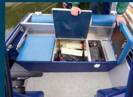
В полу носового кокпита под люком с газовым амортизатором находится переносной топливный бак. Это и оптимальной центровке способствует, да и вообще куда лучше, когда аккумуляторы и баки с горючим разнесены друг от друга. Здесь столько места, что можно и запас моторного масла хранить, и инструменты, и пластиковую бутылочку на вечер. В будущем же лодку планируется оснастить стационарным баком на 75 или 110 л.
