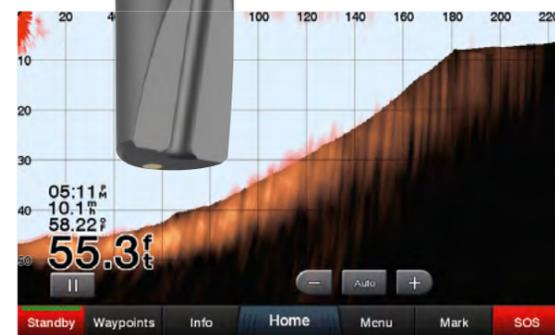
В отличие от Interphase, весь эхолот (излучатель, передатчик, приемник) собран в едином компактном корпусе обтекаемой формы, практически не создающем дополнительного сопротивления даже на высоких скоростях. Еще один плюс новинки —
